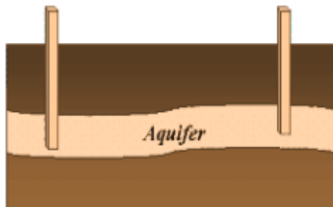
Onttrekken van grondwater (open systeem)
